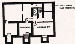
PIANTA PIANO INTERRATO - scala 1:100
